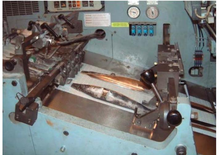
Seitenklappenfaltstation mit Saugbandtransport
