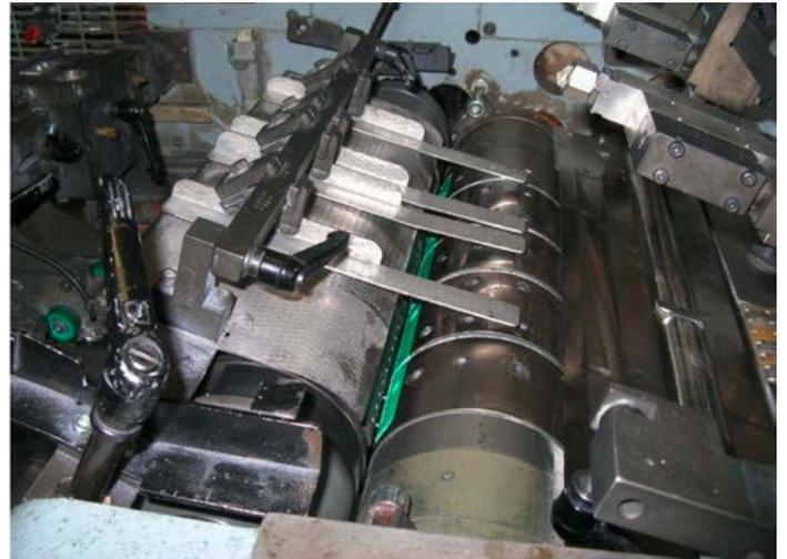
Bodenklappenfaltstation in 2-Walzen-Ausführung
