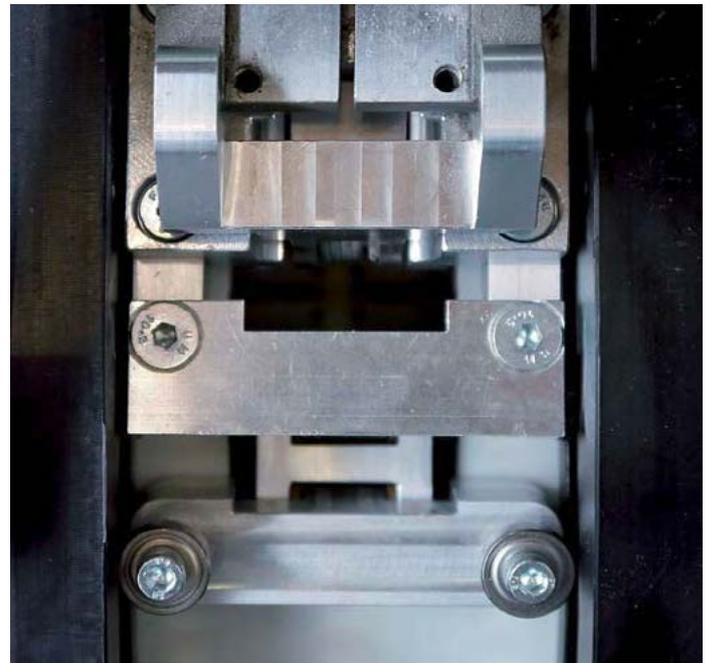
Die Greiferführungen der bewährten W+D BB700 14K sind starrer als die der aktuelleren 16K-Modelle, weshalb es an den Greifern und den Führungsschienen zu erhöhtem Verschleiß und unsicherem bzw. nicht parallel verlaufendem Transport des Briefumschlags kommen kann.
