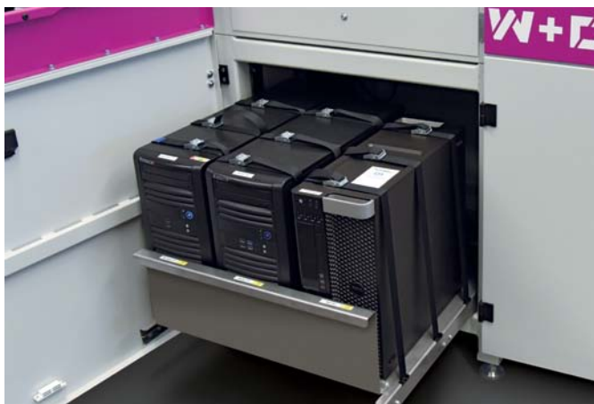
Processeur RIP, transfert des données et commande de la tête d'impression
